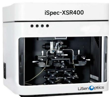
三维可调高稳定探针台结构，方便样品位置调节
