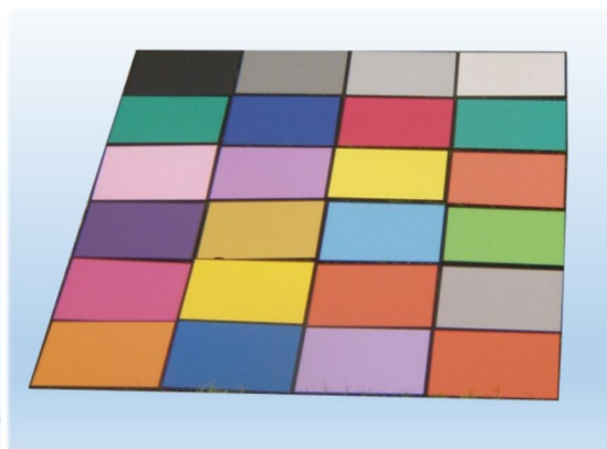
1.2米×1.2米无人机彩色及灰阶靶标
