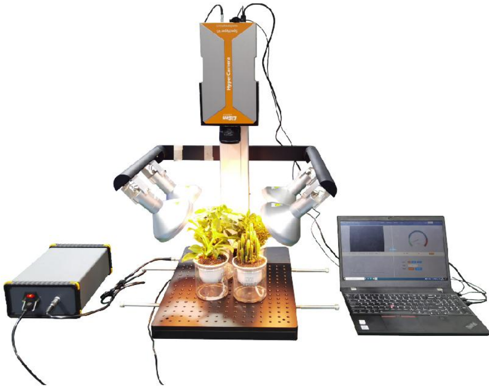
便携式高光谱成像系统方案示例图
