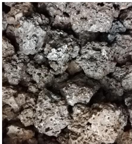
烧结矿实物图
